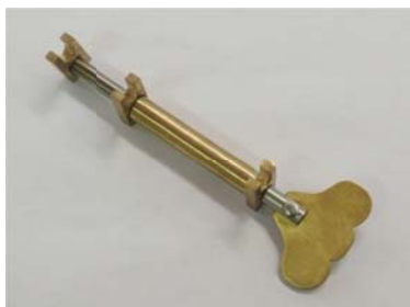
Werkzeug für Hammerköpfe entfernen
