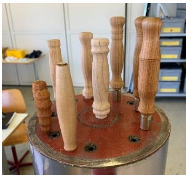
Gedrechselte und geölte Werkzeuggriffe üK B5
