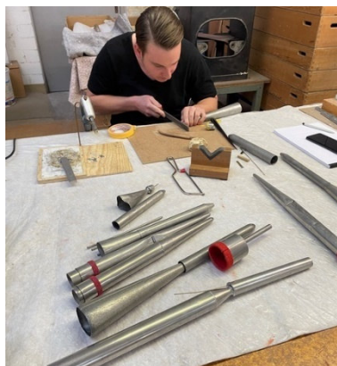
Tuyaux d'étain soudés et réparés
