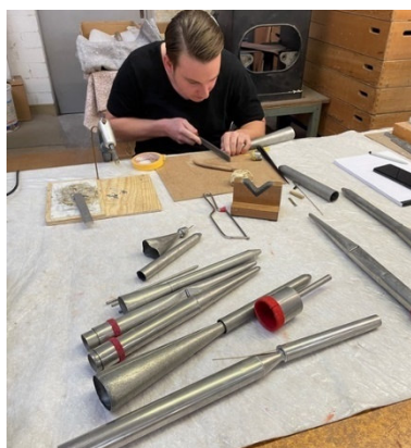
Zinnpfeifen löten und reparieren
