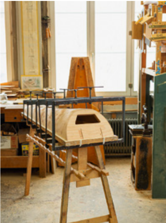
STILLEBEN IM ATELIER Blick in die Manufacture de harpes (l.), wo ein Resonanzboden geleimt und fixiert wurde (r.).
