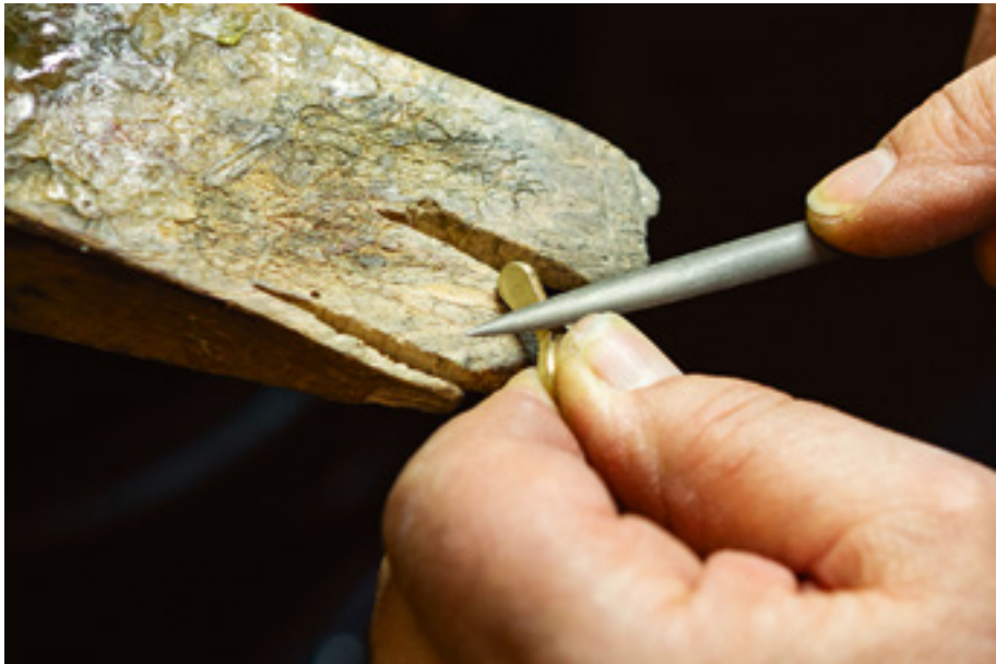
PRÄZISIONSARBEIT Mit der Feile schleift der Handwerker feinste Teile aufs gewünschte Mass zurecht.
