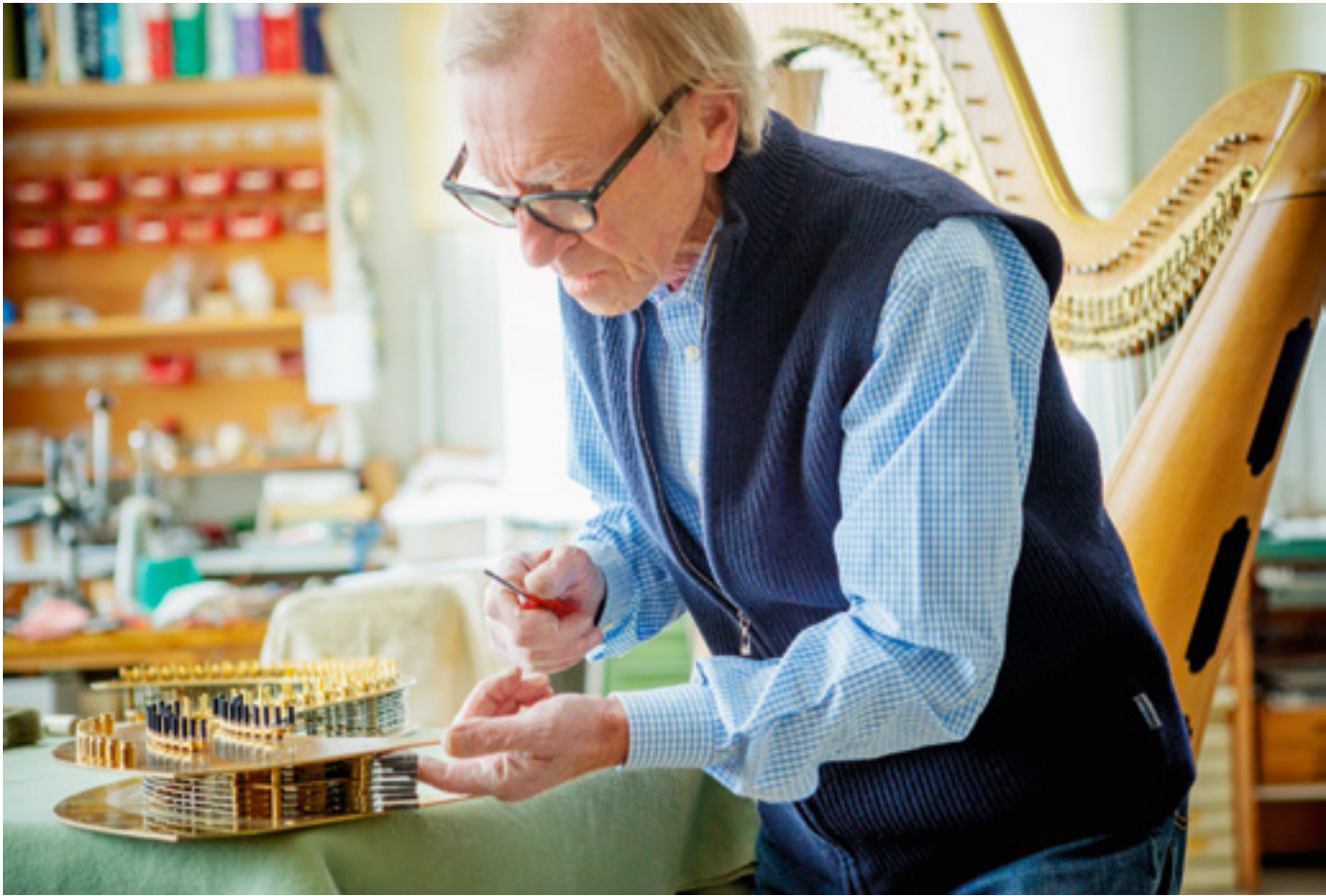
MIT PR FENDEM AUGE Bevor er die Mechanik einbaut, kontrolliert G rard David, ob sie wirklich tadellos funktioniert.
