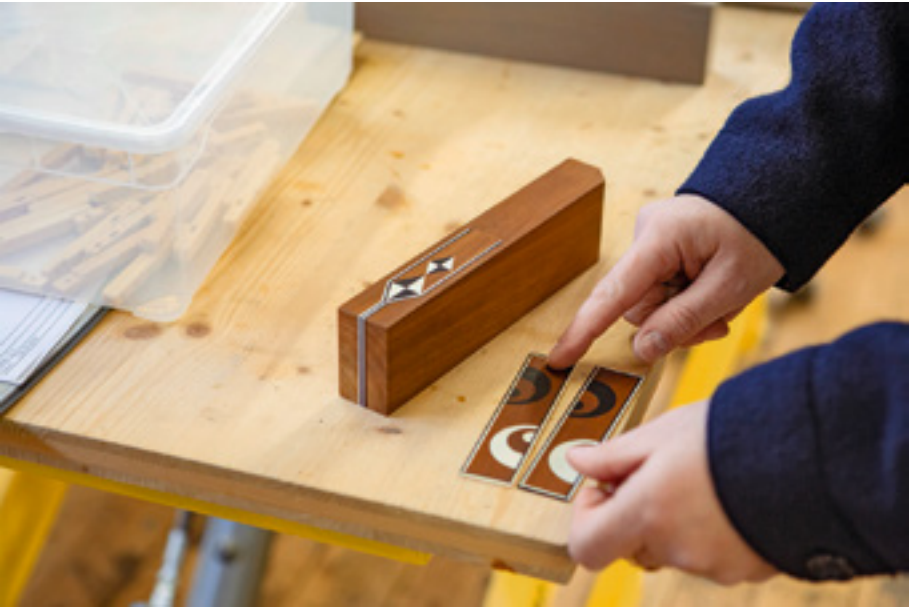
FÜRS AUGE Die Verzierungen rund um die Klaviatur zeichnet Hebeisen für jede Orgel selbst. Er verwendet dafür edle Materialien wie Ebenholz oder Mammutzahn.
