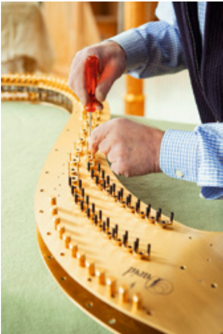
ST CK UM ST CK Die Mechanik einer Harfe besteht aus 1600 Einzelteilen, die alle im Atelier hergestellt werden. Nur die Schrauben werden zugekauft.
